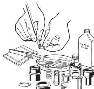
Manuele reiniging met alcohol (min. 90%)
